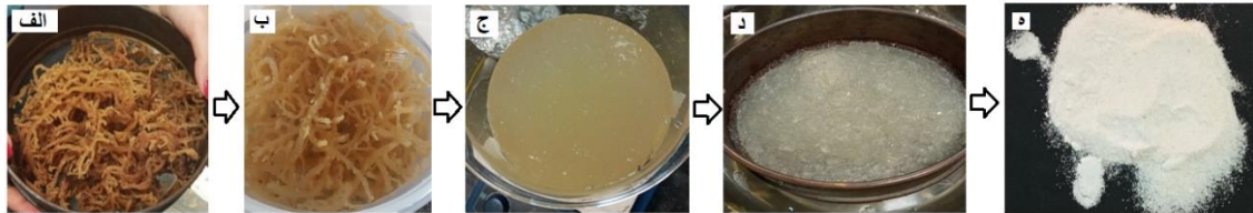
شکل ۱: الف - استخراج کاراگینان با پتاسیم کلراید و کلسیم هیدروکساید ب - شستشو و خیساندن جلبک، آماده سازی ج - کوآگولاسیون با پتاسیم کلراید د - فیلتراسیون ژل ه - پودر صمغ کاپاکاراگینان.
